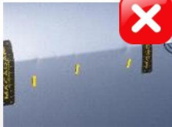
Plus de 3 «Pocs», sans détérioration de peinture et visibles jusqu'à 2 m
