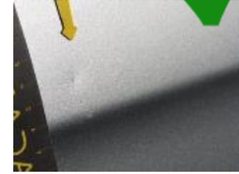
Jusqu'à 3 «Pocs»  $\leq 2$  cm de diamètre et 2 mm de profondeur, sur un même élément, sans détérioration de peinture et visibles à 2 m
