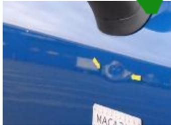
Enfoncement sans détérioration de peinture visible jusqu'à 2 m
