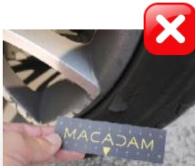
Déchirure, déformation, entaille ou arrachement de matière
