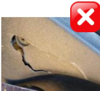
Dégradation avec perforation du support, élément cassé ou fendu
