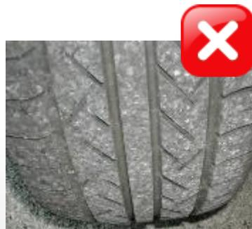
Usure anormale de la bande de roulement ou des flancs
